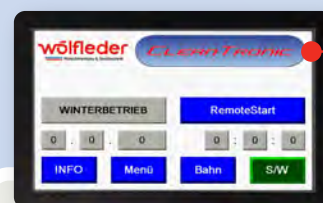
7" Zoll Touch-Display der SPS Entmistungs- steuerung
