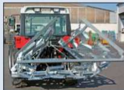
Transportstellung Wölfleder Wiesenegge 4,00 m mechanisch klappbar
