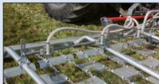
Alle Prallbleche schwenkbar, höhen- und längenverstellbar
