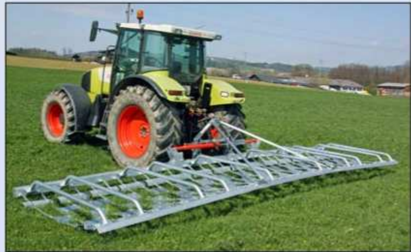
Wölfleder Wiesenegge 8,30 m hydraulisch klappbar
