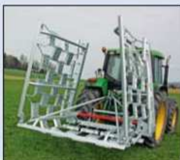
Transportstellung Wölfleder Wiesenegge 6,20 m hydraulisch klappbar
