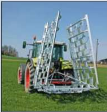
Transportstellung Wölfleder Wiesenegge 8,30 m hydraulisch klappbar
