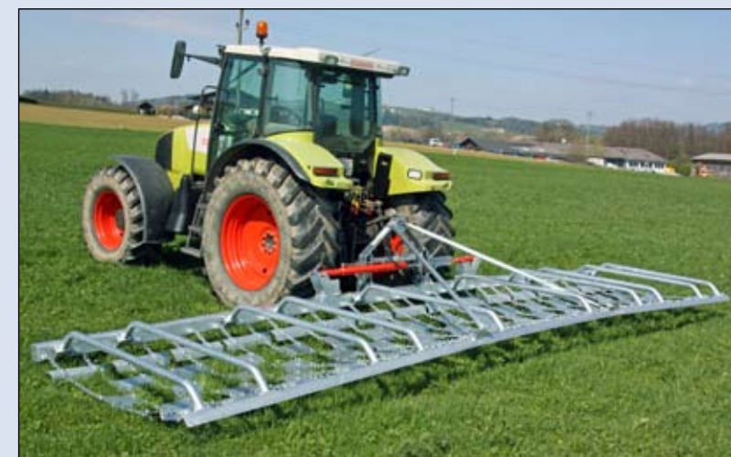
Wölfleder Wiesenegge 8,30 m hydraulisch klappbar
