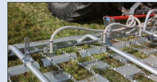
Alle Prallbleche schwenkbar, höhen- und längenverstellbar
