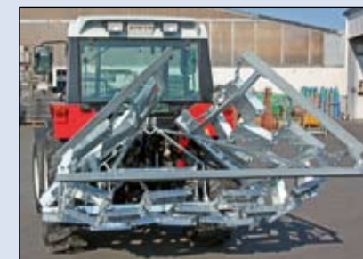
Transportstellung Wölfleder Wiesenegge 4,00 m mechanisch klappbar
