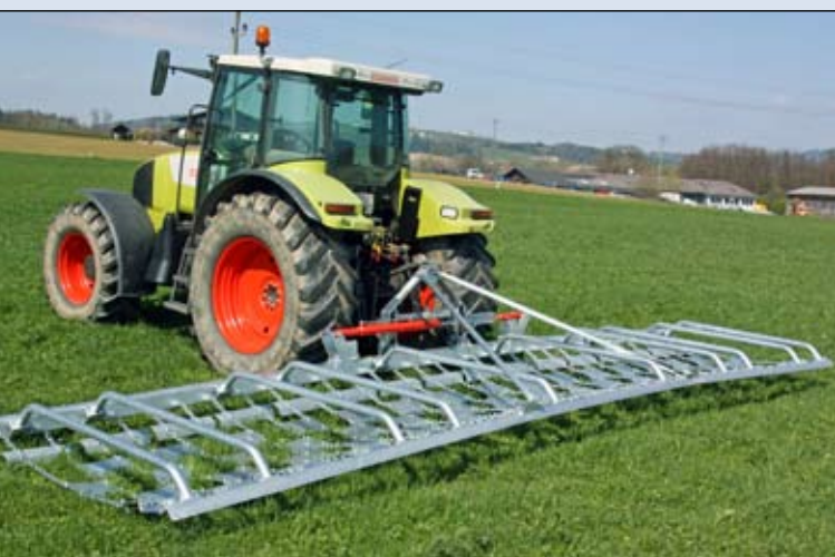
Wölfleder Wiesenegge 8,30 m hydraulisch klappbar
