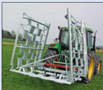
Transportstellung Wölfleder Wiesenegge 6,20 m hydraulisch klappbar
