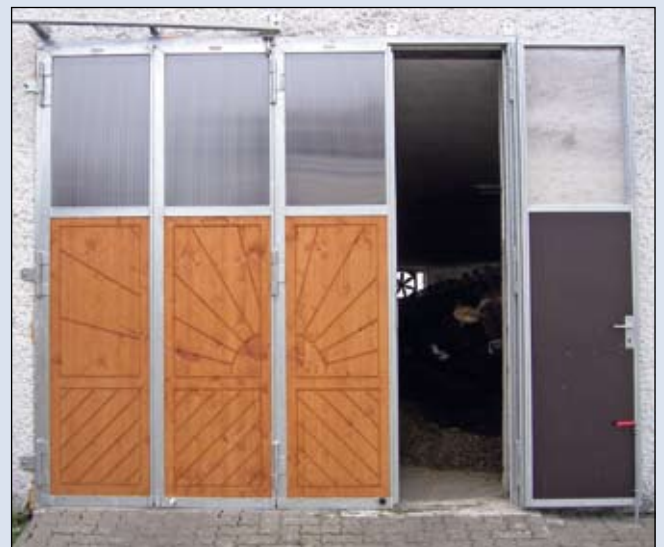
4-flügeliges Falttor mit Oberlichte und gefräster Holzfüllung außen. Füllung innen mit Betoplan. Bauart 3+1 Flügel.
