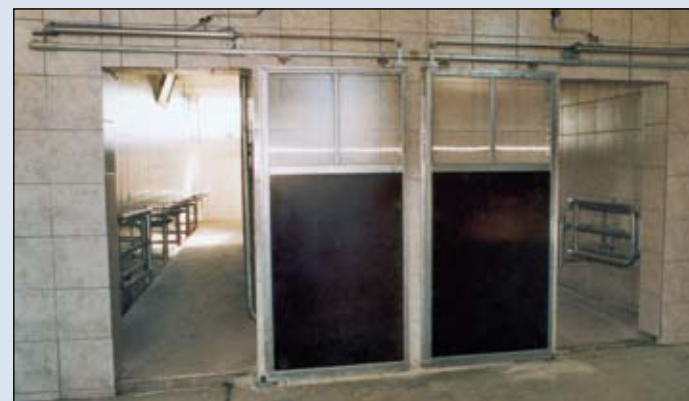
Schiebetüren für Melkstand , Füllungen aus Kunststoff oder Betoplan, Betätigung über Pneumatikzylinder
